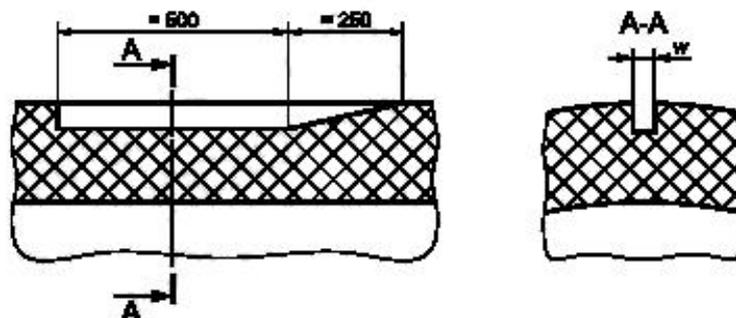
$w$  — ширина канавки (от 8 до 25 мм в зависимости от толщины стенки); острые углы на дне канавки — скруглить
