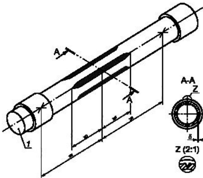
а — заглушка. б — остаточная толщина, соответствует 0,78 — 0,82 номинальной толщины стенки
