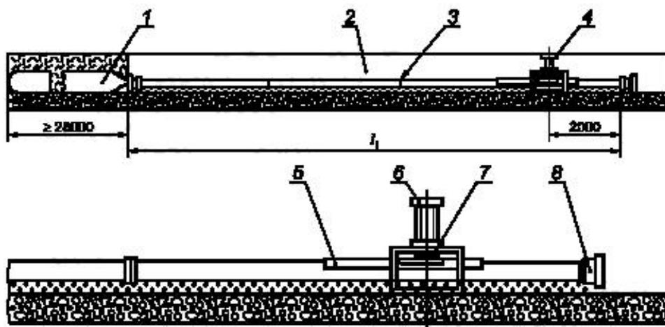
1 — стальной ресивер, 2 — канал, 3 — сварной шов, 4 — приспособление для инициирования трещины;
